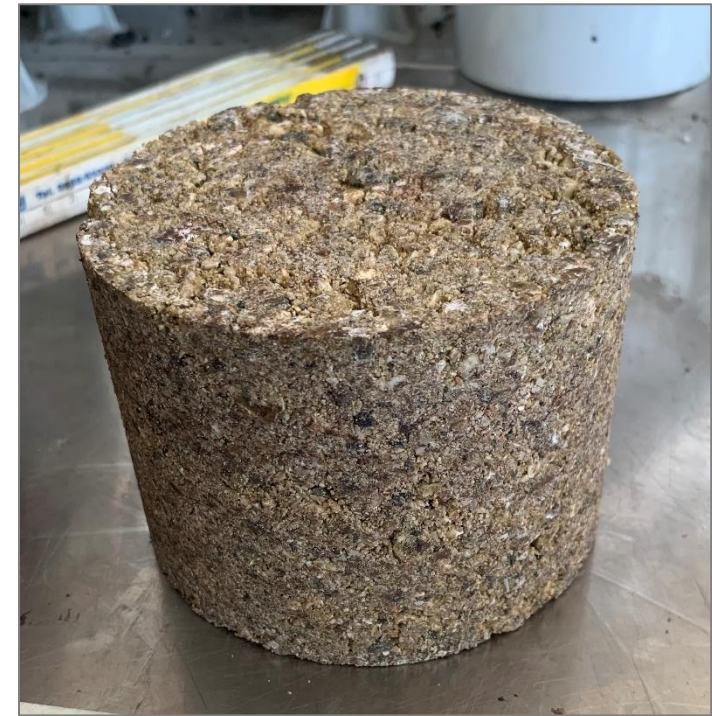
Provino compattato in laboratorio con pressa a taglio girevole
